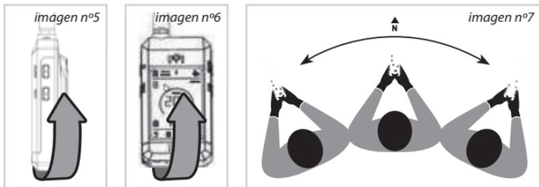
**PRECAUCIÓN:** La precisión de la flecha de dirección que señala el norte depende de un correcto calibrado de la brújula electrónica. Si detecta que la dirección mostrada es imprecisa, calibre de nuevo el dispositivo. El calibrado de la brújula se perderá si el mando se encuentra en las cercanías de otros objetos que dispongan de campo magnético. Si se da este caso deberá calibrar de nuevo el dispositivo.
