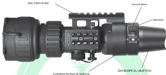
La Figura 2-4. PS 28 INSTALADO EN EL OBJETIVO DAYSCOPE
